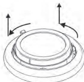
1. Sostener la carcasa orientable por el gancho de accionamiento, girar el aro retén con cristal hacia la izquierda.
