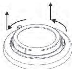
1. Maintenir le boîtier pivotant sur le crochet d'actionnement, tourner vers la gauche la bague de maintien en verre avec la rondelle.
