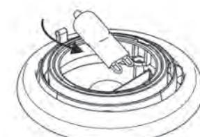
3. Laita uusi valaisuväline sisään ja valaisin on asennettava päinvastaisessa järjestyksessä jälleen yhteen
