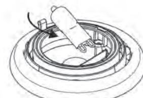
3. Sett inn ny lyspære og monter lampen igjen i motsatt rekkefølge.
