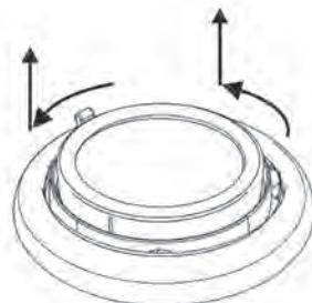
1. De draaibare behuizing tegen de bedieningshaak houden, de glashouder met glas naar links draaien.
