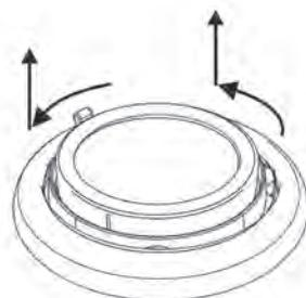
1. Das Schwenkgegäuse am Betätigungshebel halten, den Glashalter mit Scheibe nach links drehen.
