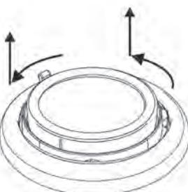
1. Podržte otočné teleso na upevňovacom háku, sklenený prídržný krúžok otočte smerom doľava.
