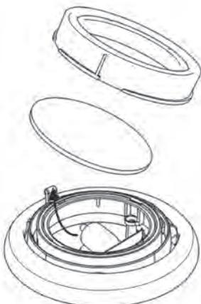
2. Retirer la bague de maintien en verre et la rondelle.
