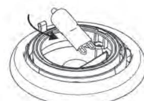
3. Insérer une nouvelle ampoule et remonter la lampe en procédant en sens inverse.
