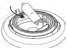
3. Colocar a lâmpada nova e voltar a montar a lâmpada na ordem inversa.
