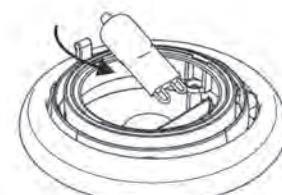
3. Colocar la nueva lámpara y volver a montar la luminaria en la secuencia inversa.
