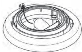
3. Vložte nový osvetľovací prostriedok a zmontujte znova svietidlo v opačnom poradí.
