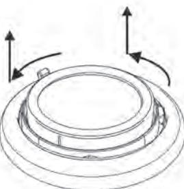
1. Segurar a caixa do basculador no encaixe de actuação, rodar o anel de suporte de vidro com o vidro para a esquerda
