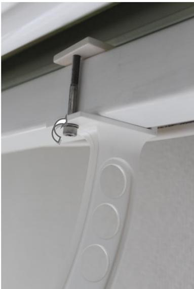
3) Zugeklappte Tragrohrhalterung mit Zylinderkopfschraube M4x50 (mit Unterlegscheibe) am Tragrohr verschrauben (Innensechskantschlüssel 4mm)
